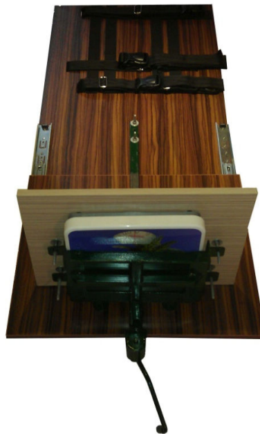
شکل (۲)- تصویری از دستگاه ساخته شده برای اعمال نیرو به کف پای اجساد جهت شبیه‌سازی نیروی عمودی حاصل از وزن بدن
