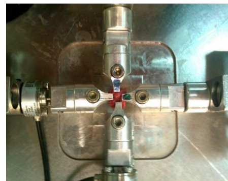
شکل (۴) - نحوه‌ی قرارگیری نمونه در دستگاه
