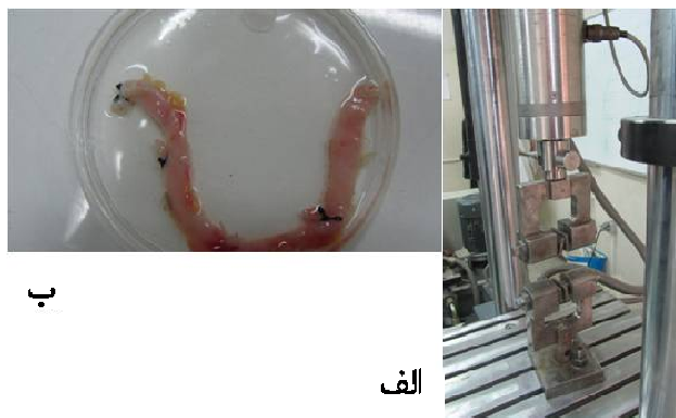
شکل (۱) - الف: دستگاه کشش ب: نمونه شسته شده سافنوس
