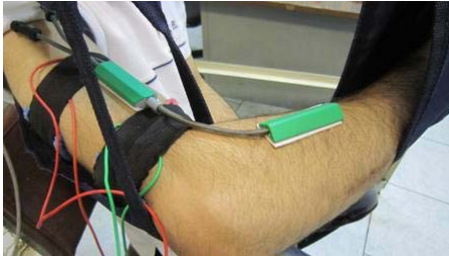
شکل ۲- وضعیت قرارگیری فرد و دست وی حین انجام آزمایش‌ها. نحوه‌ی نصب الکترودهای بازو و زاویه‌سنج روی دست. دستگاه تحریک الکتریکی در سمت چپ شکل بالا دیده می‌شود.
