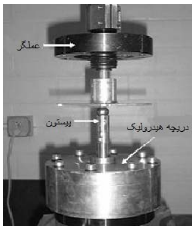
شکل ۱- سیستم تحریک مکانیکی سلول‌های کشت شده تحت فشار هیدرولیکی (اقتباس شده از [۴])
