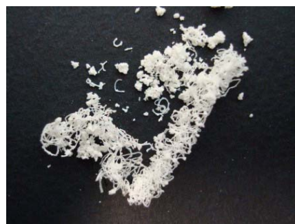
شکل ۱- نمونه‌ای از الیاف شیشه‌ای ساخته شده به روش سل ژل
