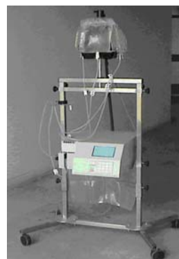
شکل ۱- دستگاه دیالیز صفاقی ساخته شده
