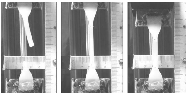
شکل (۱) - نمونه دمبل شکل تحت آزمون کشش
