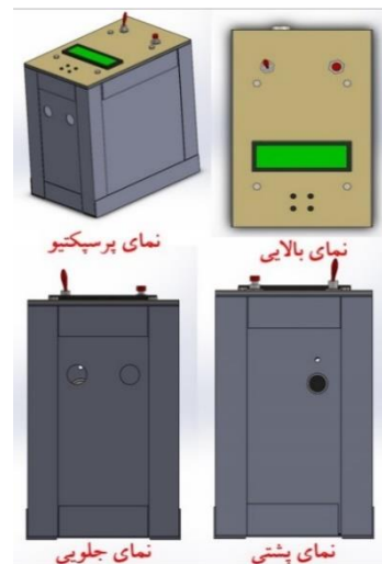
شکل (۹) - نمای بدنه‌ی طراحی شده برای دستگاه در نرم افزار solid works
