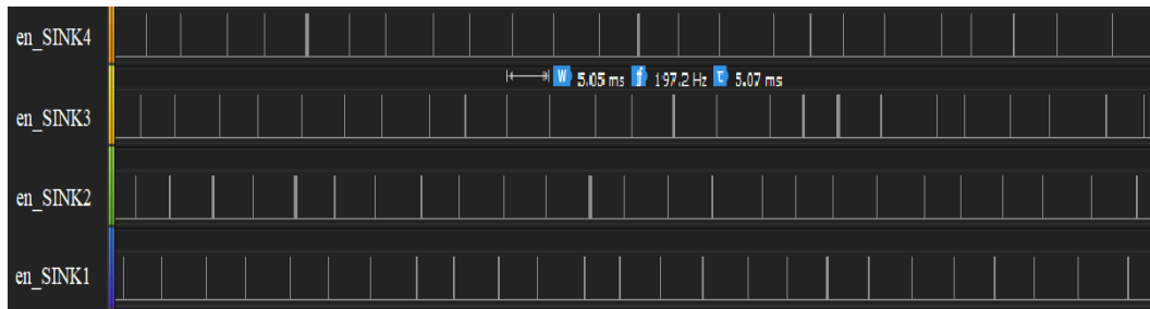
شکل (۱۰) - دورنمایی از سیگنال‌های پالس‌های خروجی حاصل در تحریک هم‌زمان چهار کانال با فرکانس ۰/۲ کیلوهرتز
