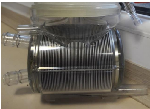
شکل (۵) - مبدل حرارتی
