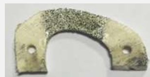
شکل (۴) - ایجاد الگوی لک روی قسمت طول موثر ۱ نمونه‌ها (منطقه‌ای که بیشترین تنش کششی را دارد) به منظور انجام روش برهم‌نگاری تصاویر دیجیتالی
