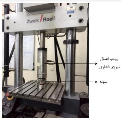
شکل (۳) - دستگاه تست دینامیکی مورد استفاده در تست ریلکسیشن
