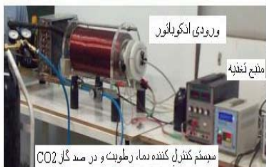
شکل ۲- تصویری از بوبین به همراه سیستم کنترل کننده دما، رطوبت و گاز CO_2 دیده می‌شود.
