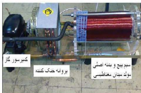
شکل ۱- تصویری از مولد میدان مغناطیسی ایستا- بوبین- که در آن بدنه اصلی، پروانه خنک کننده و کمپرسور گاز فرئون دیده می‌شود.
