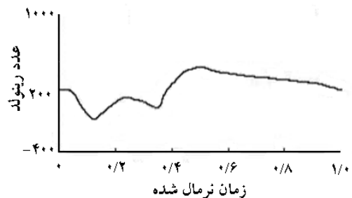
شکل ۵- پالس کرونری LAD به کار برده شده به عنوان شرط مرزی ورودی برای کرونری
