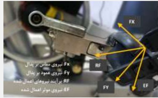
شکل (۴) - مکان قرارگیری، نحوه‌ی اتصال سنسور نیروسنج به پدال دوچرخه و نوع نیروهای اعمالی به پدال
