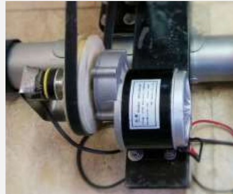
شکل (۷) - سیستم محرکه‌ی دوچرخه‌ی ثابت، شکل و مکان قرارگیری موتور الکتریکی و سنسور سرعت‌سنج
