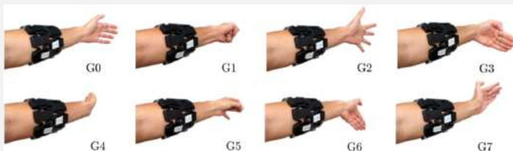
شکل (۵) - حالات مختلف حرکت در وضعیت اشاره‌ی دست شامل حالت‌های استراحت ( G_0 )، مشت بسته ( G_1 )، دست بسته ( G_2 )، ژست موج دست به سمت داخل ( G_3 )، ژست موج به سمت بیرون ( G_4 )، دوبار ضربه ( G_5 )، دست به سمت پایین ( G_6 ) و دست به سمت بالا ( G_7 )
