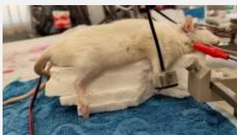
شکل (۳) - نحوه‌ی اتصال سنسور شتاب‌سنج به دست راست رت
