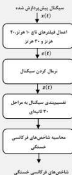
شکل (۳) - نمودار بلوکی روند تعیین شاخص‌های فرکانسی خستگی، x(t) نشان‌گر سیگنال پیش پردازش شده، e(t) نشان‌گر سیگنال فیلتر شده با فیلترهای ناچ ۱۰، ۲۰ و ۳۰ هرتز و z(t) نشان‌گر سیگنال نرمال شده است
