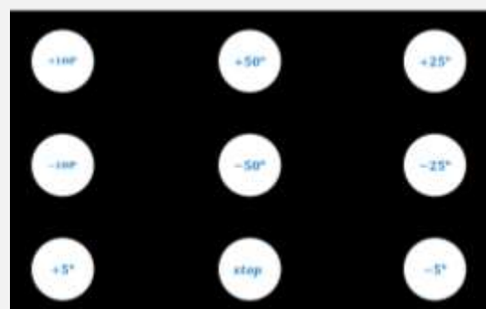
شکل (۲) - تصویر شماتیک صفحه‌ی نمایش گر تحریک دیداری، مقدار تغییرات زاویه‌ای متناظر با هر نشانه درون دایره قابل مشاهده است
