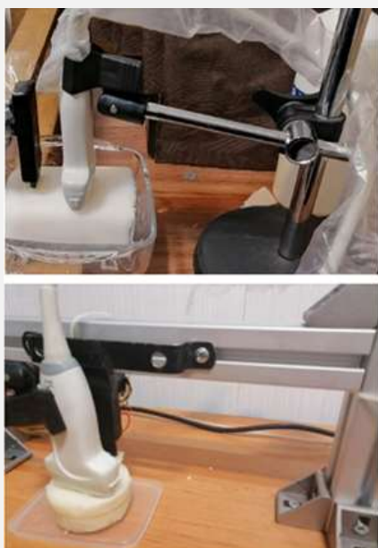
شکل (۲) - تصویر بالا: نحوه‌ی قرارگیری پایه‌ی نگهدار، کاوش‌گر و لرزاننده روی سطح فانٹوم [۲۴]. تصویر پایین: پایه‌ی نگهدار طراحی شده برای ثبت از نمونه بافت‌های خارج شده.
