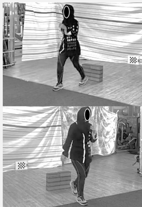
شکل (۱)- زاویه دید دوربین‌های سیستم اوپن کپ نسبت به مسیر حرکتی آزمودنی، موقعیت مانع و فریم کالیبراسیون
