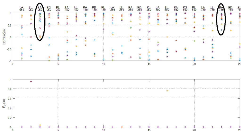
شکل (۶) - (بالا) ضریب همبستگی بین حجم تجمعی آگیری و شاخص امپدانسی مرکب هر فرکانس/مقطع. محور افقی شماره فرکانس/مقطع است. (پائین) مقدار P-value که میزان معنی دار بودن ضریب همبستگی را نشان می دهد
