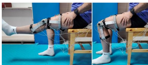
شکل (۲) - چیدمان آزمایش برای آزمون خم و باز کردن زانو. راست: وضعیت آزمودنی در آغاز حرکت؛ چپ: در حداکثر بازشدگی زانو.
